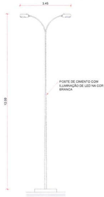
DETALHE 01 PLANTA POSTE
